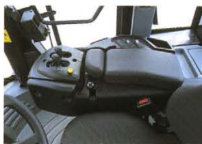
アームレスト一体型のE&Hコントロール作業機レバー
