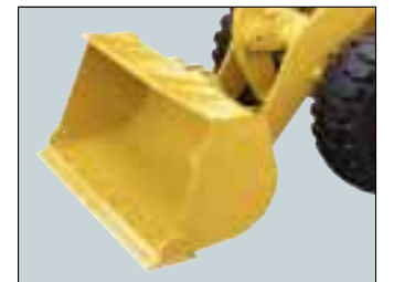
3.8m 3 バケットは比重1.8で設定しています。
