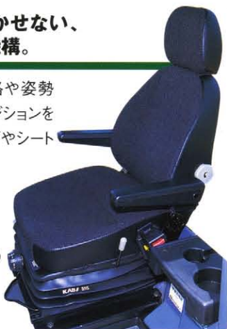
ファブリックサスペンションシート (巻込み収納式シートベルト装備)
