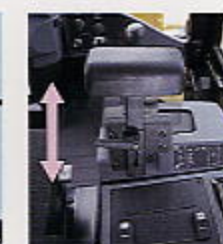
上下調整可能な 作業機レバー用リストレスト
