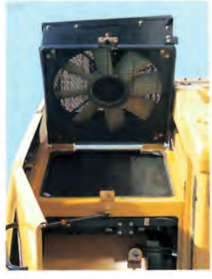
ラジエータファン部がヒンジで開閉可能
