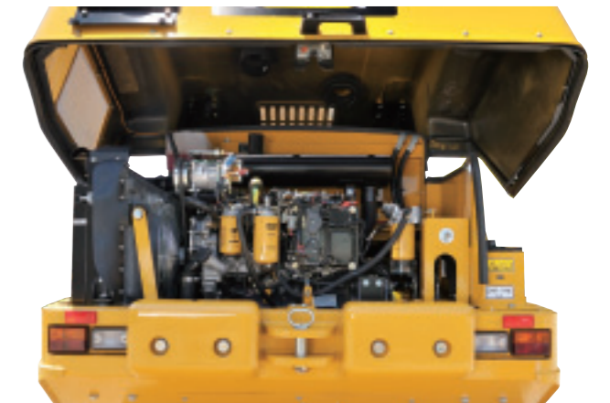
抜群の車両安定性を実現するエンジン横置きレイアウト
