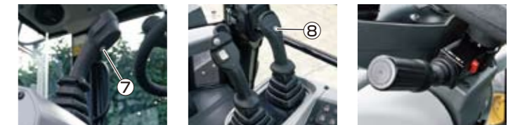
3バルブ/4バルブジョイスティック(オプション) コラムシフト
