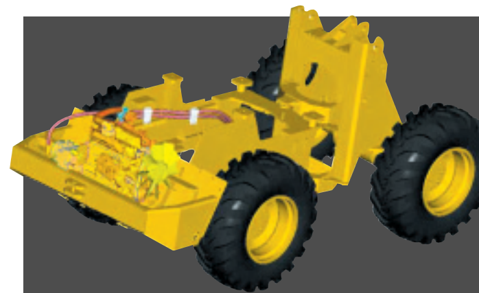
抜群の車両安定性を実現するエンジン横置きレイアウト
