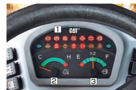
1 各種警告灯 2 冷却水温度計 3 燃料計
