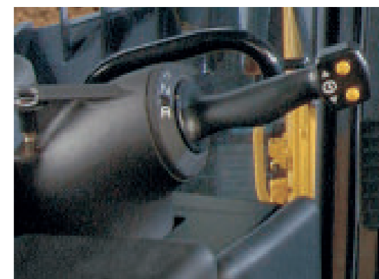
▲1本のハンドルで前後進切替と変速操作、旋回角度とスピード調整が行えます。
