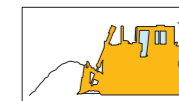
前進2速 後進2速モード 一般的な整地・はなかけ作業などの軽・中負荷作業に有効
