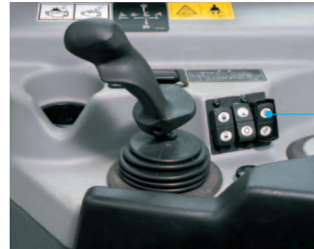
作業装置ロックスイッチ 乗降時などの不意の誤操作を防止する、作業装置用ロックスイッチを装備。
