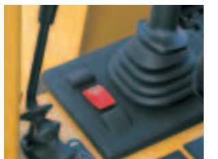
ON時のみエンジン始動が可能な、 電気式駐車ブレーキスイッチ
