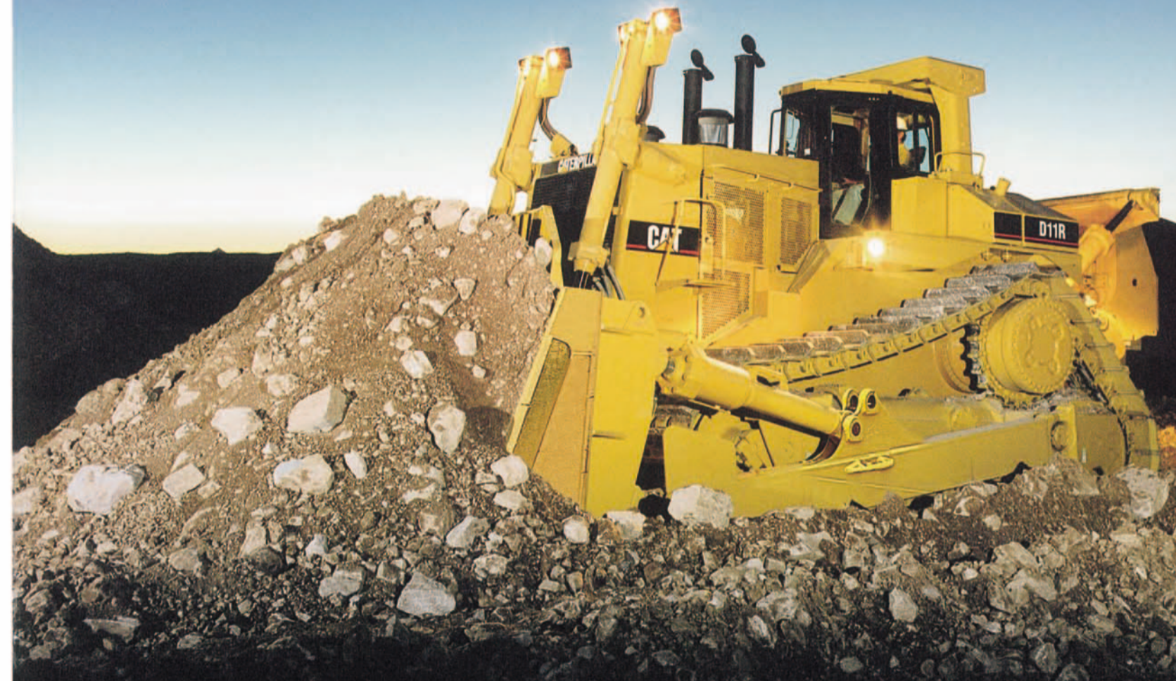
図はセミユニバーサルドーザ、シングルシャックリッパ付を示します。
