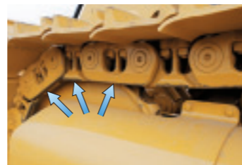
▲ リンクレールがアイドルと接触しないセントラックアイドルの採用により、三日月摩耗を防止します。
