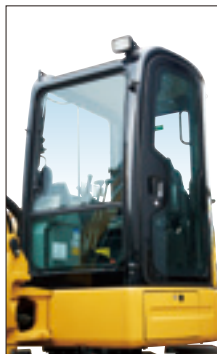
ROPS：転倒時保護構造 (ISO12117-2)
