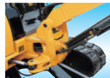
▲コンパクトにポスト内を通過させ、見た目すっきり。
