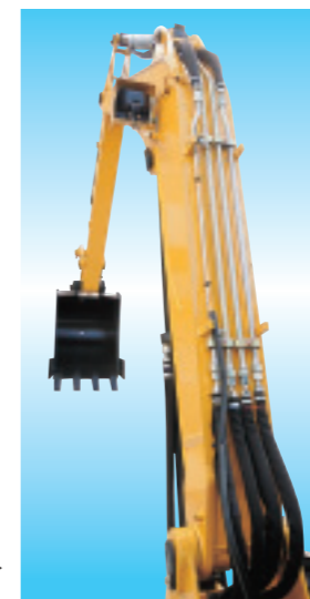
▲コンパクトにポスト内を通過させ、見た目すっきり。
