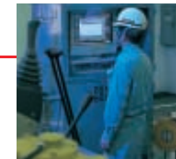
製造ラインでの、作動油清浄度測定風景
