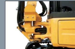
先端の鋳造化により応力集中を防止した高品質、高信頼のブームポスト。作業機への油圧配管をブームポスト内に収納しています。
