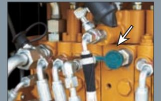
オイルチェックが容易に行えるSOSサンプリングバルブを設置しています。
