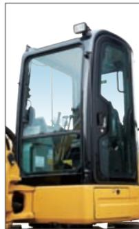
ROPS規格クリアのキャブは、ヒータを標準装備しています。はね上げ式のフロントガラスの採用により作業時の利便性や通気性を高めています。
