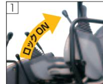
1 油圧ロックレバーを上げることで全作業機を油圧ロック可能
