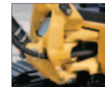
作業機への油圧配管をブームポスト内に収納
