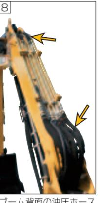
8 ブーム背面の油圧ホースの飛散防止用ファブリックカバー
