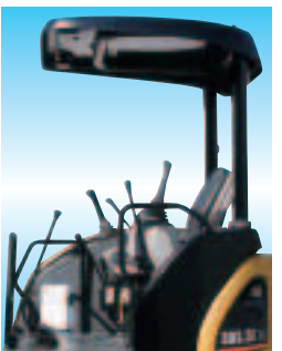
全作業機油圧ロック作業時
