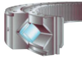
円筒形のローラを縦横に組み合わせたクロスローラベアリングを採用。縦方向のガタを低減し、長期にわたってスムーズな旋回性を維持します。
