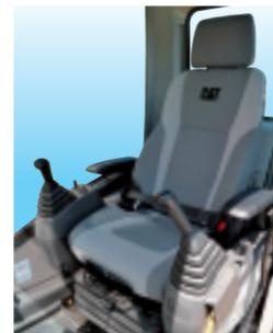
ライト&ダークグレーのツートンカラーと落ち着いた色調の新型エアサスペンションシートを標準装備。クッション硬さ、体重調節やコンソール高さの調整などオペレータに最適なシートアレンジが可能です。また、静電気帯電防止加工により、静電気による不快感を払拭しました。
