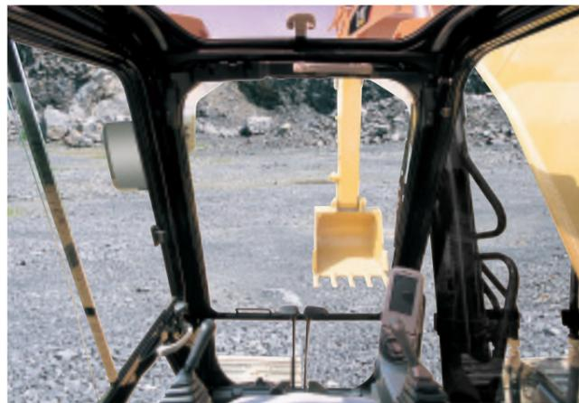
異形鋼管フレームにより、FOGS（落下物保護構造）直付けを可能にする高い強度とワイドな視界を実現。ワイドなキャブ幅に加え、スリムな新型フルグラフィックカラーモニターにより広い足元スペースを確保しました。
