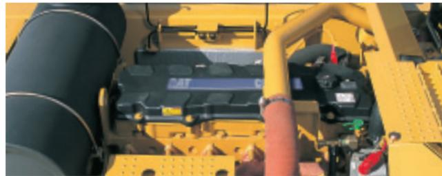
定格出力 **200kW (272PS) / 1,800min<sup>-1</sup> (1,800rpm)**
