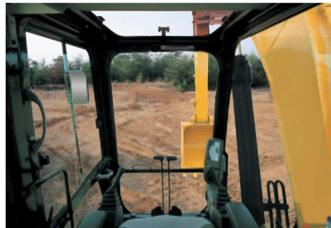
異形鋼管フレームにより、FOGS(落下物保護構造)直付けを可能にする高い強度とワイドな視界を実現。ワイドなキャブ幅に加え、スリムな新型フルグラフィックカラーモニタにより広い足元スペースを確保しました。
