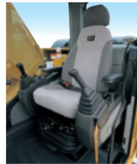
ライト&ダークグレーのツートンカラーと落ち着いた色調の新型ファブリックシート。静電気帯電防止加工により静電気による不快感も払拭しています。ホールド感を向上させたクッションに加え、リクライニング角や高さなどのシートアレンジ機能も充実しています。
