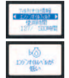
油水レベルオートチェック機能 エンジン始動前にエンジンオイル、作動油、冷却水量が規定値より少ない場合には、警告を表示。
