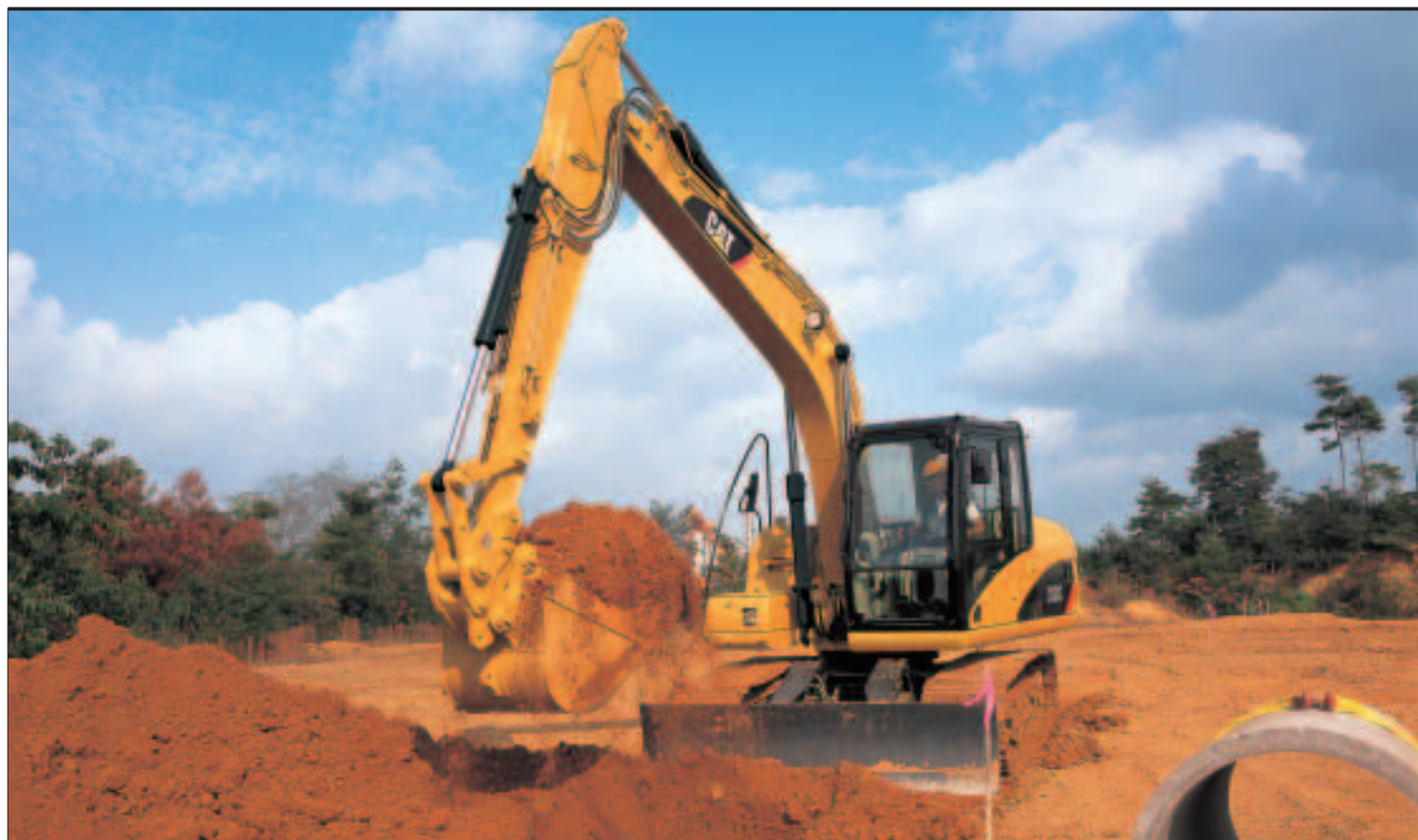
写真は海外仕様です。(リフティングバー付パワーリンク、バケット回ワグリスライン、3mロングアーム、中圧・共用配管、クイッククラブ、ブレード装着車)
