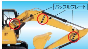
内部に設置したハニカムプレート(補強材)で高強度を実現
