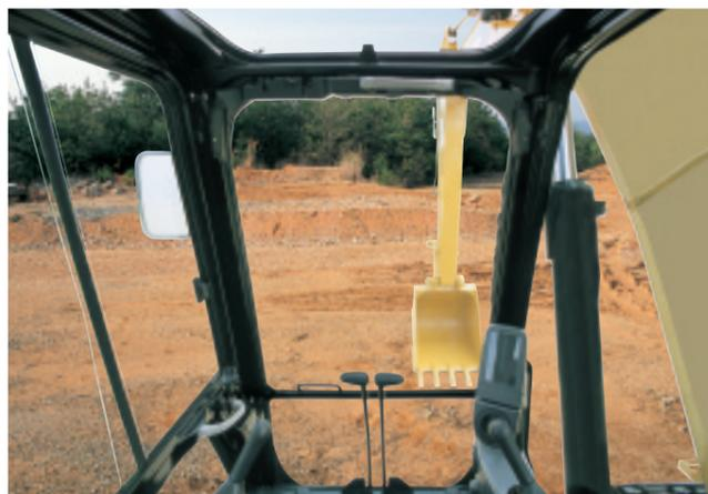
汎用小旋回機ながら標準機と同じキャブを採用。異形鋼管フレームにより、FOGS(落下物保護構造)直付けを可能にする高い強度とワイドな視界を確保しました。広いキャブ幅に加えスリムな新型フルグラフィックカラーモニターにより足下スペースも広く、ゆとりの操作空間を実現しました。
