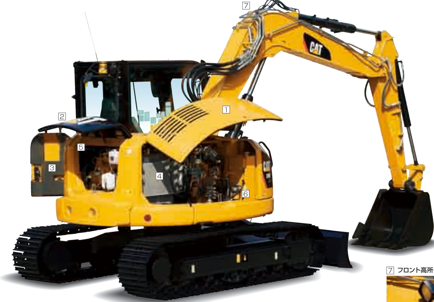
2 点検箇所を集中させたエンジンサービスドア
