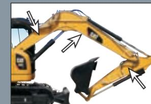
大断面構造と内部のバッフルプレート（補強材）によりフロント部の強度を高めています。[CR]
