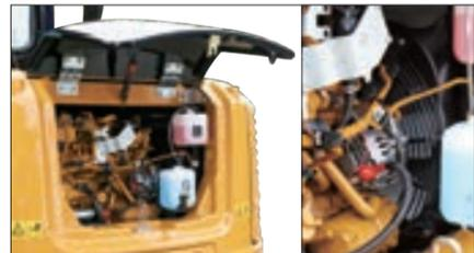
プルアップ式サービスドアを開けるだけでエンジンの日常点検が行えます。また、エンジンファンガードが点検時の安全を確保します。
