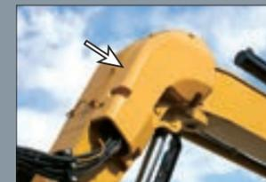
フロント部油圧機器の破損防止で信頼性を高める配管&シリンダガード。[SR]
