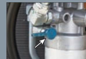
オイルチェックが容易に行えるSOSサンプリングバルブを設置しています。
