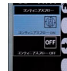
モニタで切替えます。スライド式ホイールスイッチのON/OFFによりアタッチメントを連続作動させることが可能です。オペレータへの負担を軽減します。
