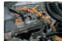
難燃性、耐熱性にすぐれた イエローレド被覆の配線
