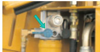
作動油およびエンジンオイルチェックが 容易なSOSサンプリングバルブ
