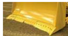
パフォーマンス カッティングエッジ オプション 硬い地面を掘削し、材料を移動するのに適しています
