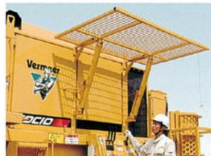
▲上部からの飛散落下物に備えてプロテクターを装備。
