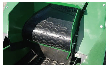
フィーダから排出コンベヤに供給されます
