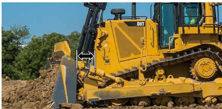
ブレードを車体に近づけることで機械長を短くし、操作性、バランス、貫入力、掘起力を改善
