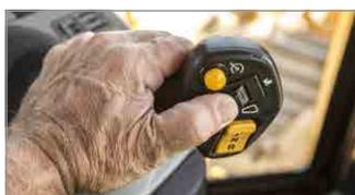
ジョイスティックのローラを親指で回し、簡単に速度調整できるので、オペレータの疲労が低減します
