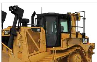
十分に全方位の視界性を確保したROPSキャブで安全で安心キャブ内の騒音も低減しておりオペレータはより快適にストレスなく作業できます
