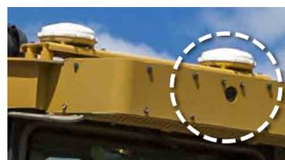
カメラは埋め込み式で、万が一の接触による破損を回避。後方の視界をより広くとらえやすいキャブ後方上部に設置
