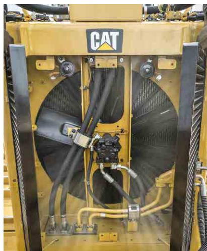
ファンを逆回転させてラジエータコアに詰まったゴミ、粉塵を吹き飛ばしコアの清掃間隔を延ばします
