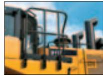
キャブ左右に設置された大型のガードレールが昇降時の安全性を高めます。
