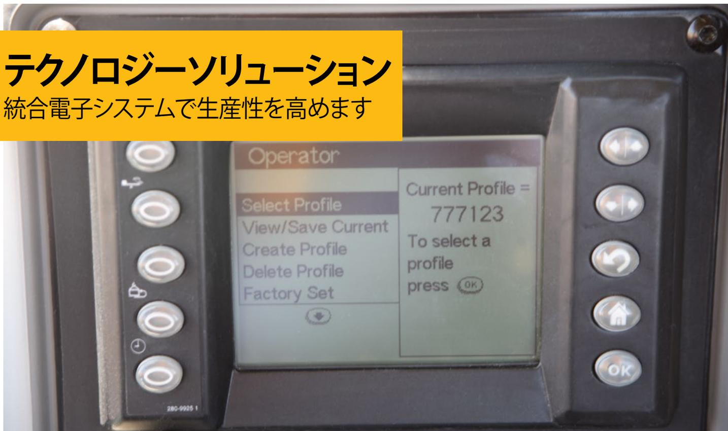
993Kに搭載されているエレクトロニックシステムは、統合された手足のように機能するように設計されています。これによりスマートマシン化が可能となり、オペレータはより多くの機械情報を得られ機械とオペレータ双方の生産効率が高まります。
