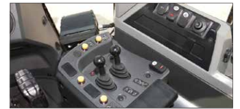
EHコントロール
