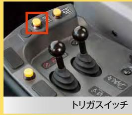
オペレータがトリガスイッチ(左写真内赤枠)を押した後に自動掘削が開始されます
