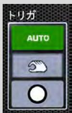
バケットが荷に接触すると自動で掘削を開始します
