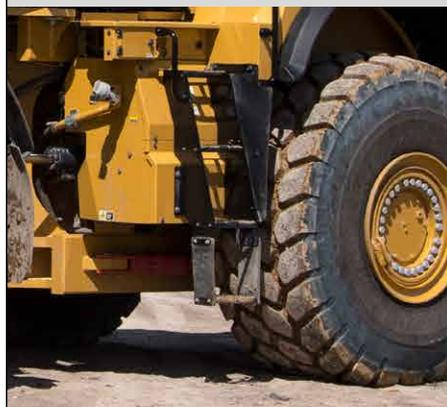
左右のラダーとともに傾斜角度が大きく階段に近い感覚で安全に乗り降りができます
