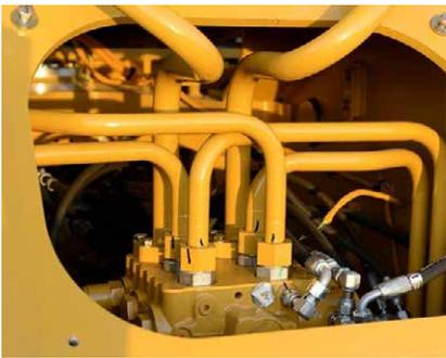
モノブロック（一体成型）のバルブを採用し、油漏れのリスクを低減しています
