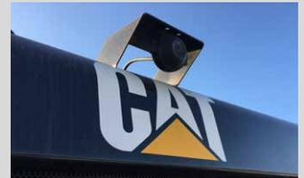
カメラは機体後部上端の中央に設置
