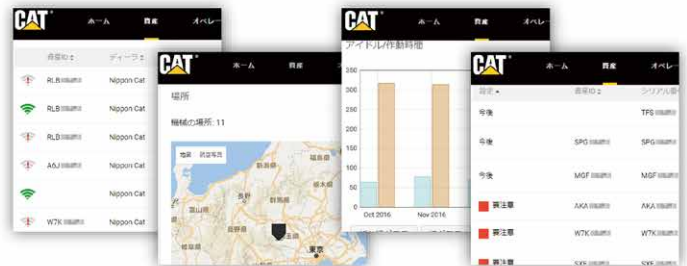
※ PL (Product Link™) は携帯/衛星通信網を使った車両遠隔管理システムです
