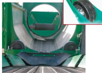
スクリーンドラムを4輪ローラで支持し、4つのモーターで駆動することで回転させます。スムーズな回転による高精度の選別が行えます。
