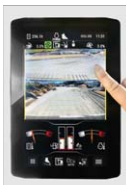
後方&右側カメラ(水平分割2画面)
