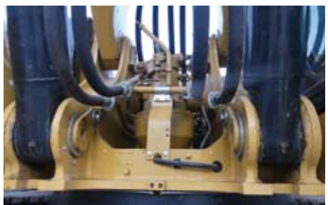
スイングフレームを大型化 溶接部を増加し、強度をアップ
