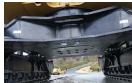
スィベルガード標準装備 カーボディ強度がさらに向上
