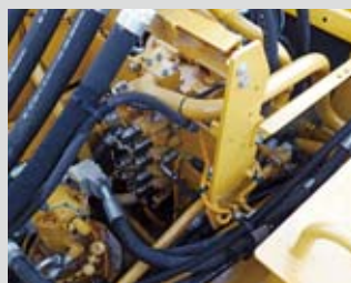
高効率な電子制御コントロールバルブ
