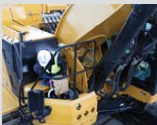
ハンドレールで囲まれた安全な スペースで尿素水を補給可能
