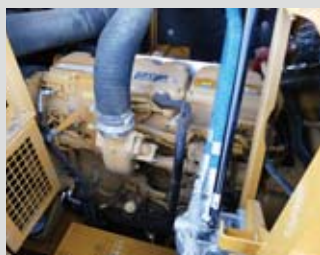
定格出力(ネット)404kWと高出力 Cat® C18ディーゼルエンジン
