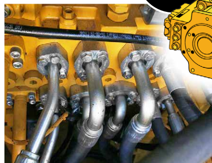
電子制御油圧ポンプ
