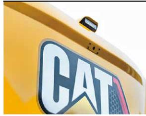
車両の後、左右の計3か所にLEDライトを追加で設置
