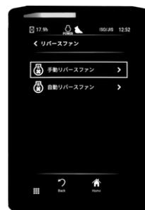
任意のタイミングで作動できる「手動」と稼働間隔等をあらかじめ設定しておくことで自動で稼働する「自動」が選択でき、いずれもモニタで簡単に設定、実行できます
