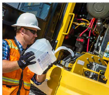
尿素水タンク(ラジエタールーム内)
