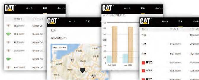
※ PL (Product Link™) は携帯/衛星通信網を使った車両遠隔管理システムです
