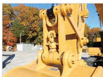
全格納式フックタイプ吊具
