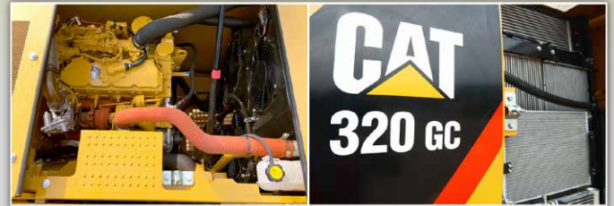
エンジンルームとラジエタールーム
