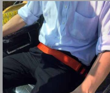
鮮明なカラーのシートベルトなので、オペレータのシートベルトの装着状況を一目で確認することができます
