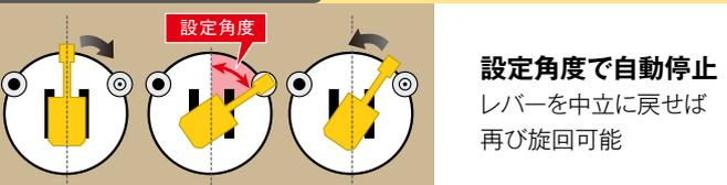
⑤ チルトアシスト **New** ブーム操作で設計面に近づくとバケット角度を自動補正し作業効率が大幅に向上
