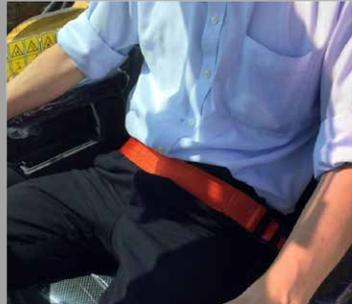
鮮やかなカラーのシートベルトなので、オペレータのシートベルトの装着状況を一目で確認することができます
