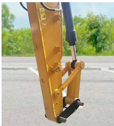
各強化型アーム・バケットリンケージ・バケットシリンダ
