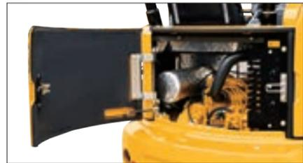
横開きのサービスドアを開けるだけでエンジンの日常点検が行えます。
