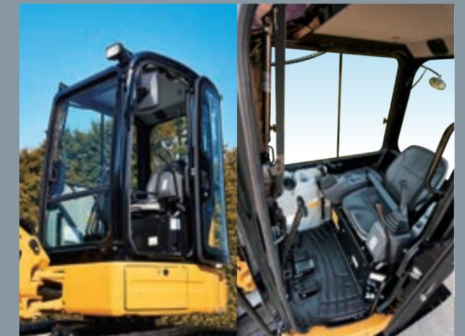
油圧ショベルのROPS規格をクリアしたキャブは、ヒータを標準装備しています。はね上げ式のフロントガラスの採用により作業時の利便性や通気性を高めています。
