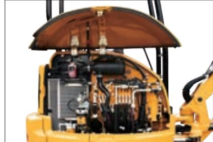
サイドカバーは、アシスト付で軽く開くフルオープンタイプです。広い開口部により点検各所へのアクセスが地上からラクに安全に行え、メンテナンスにかかる時間と手間を大幅に軽減します。
