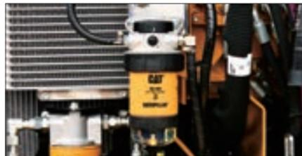
燃料フィルタには、ウォータセパレーター型を採用しています。
