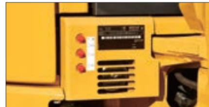
旋回ベアリング部とスイングシリンダ部への給脂を1カ所にまとめたリモート集中給脂を採用しました。
