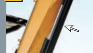
山型形状の強化型boomシリンダガードを標準装備
