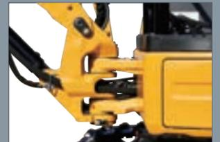
先端の鋳造化により応力集中を防止した高品質、高信頼のboomポスト。作業機への油圧配管をboomポスト内に収納しています。
