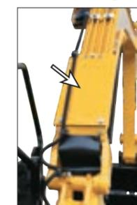
オペレータに面したブーム背面の油圧ホースには、万一の時にも安心な飛散防止カバーを設置しています。
