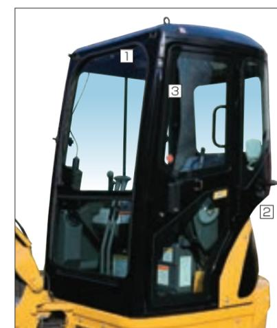
ワイドなキャブは、ヒータやシートベルトを標準装備しています。強化ガラス採用のはね上げ式フロントウインドの採用により作業時の利便性や通気性を高めています。
