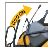
油圧ロックレバーをはね上げることで作業機(ブレード、ブームスイングを除く)、旋回、走行をロック可能。また、油圧ロック時にしかエンジンが始動しないエンジンニュートラルスタート機構も装備しています。
